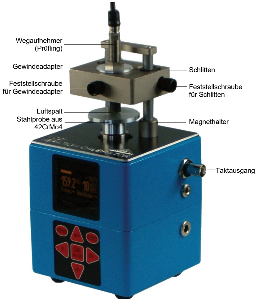
Bild 2: VC21D mit Adapter für Wegaufnehmer und Taktausgang
