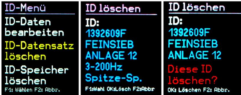
Bild 19: Löschen eines Messpunktdatensatzes
