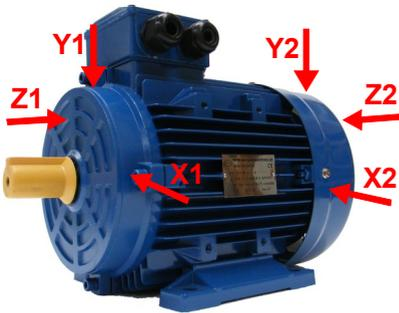
Bild 12: Messorte an Elektromotoren
