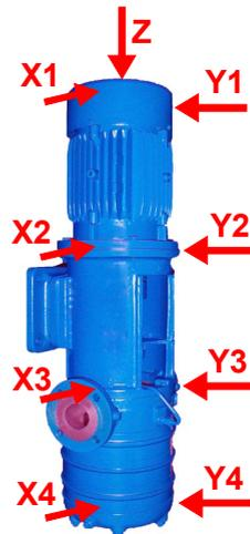
Bild 13: Messorte an Maschinen mit vertikalem Rotor
