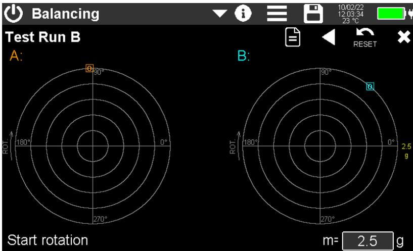
Bild 67: Testmasse anbringen an Ebene B (2 Ebenen)
