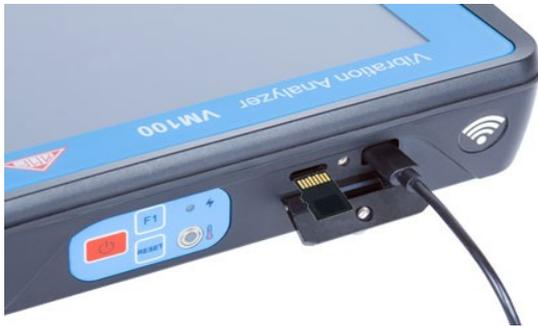
Bild 10: USB-/Ladebuchse und SD-Karte
