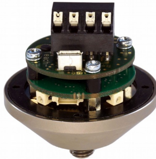
Bild 1: Anschlussklemmen und USB-Buchse im VS11
