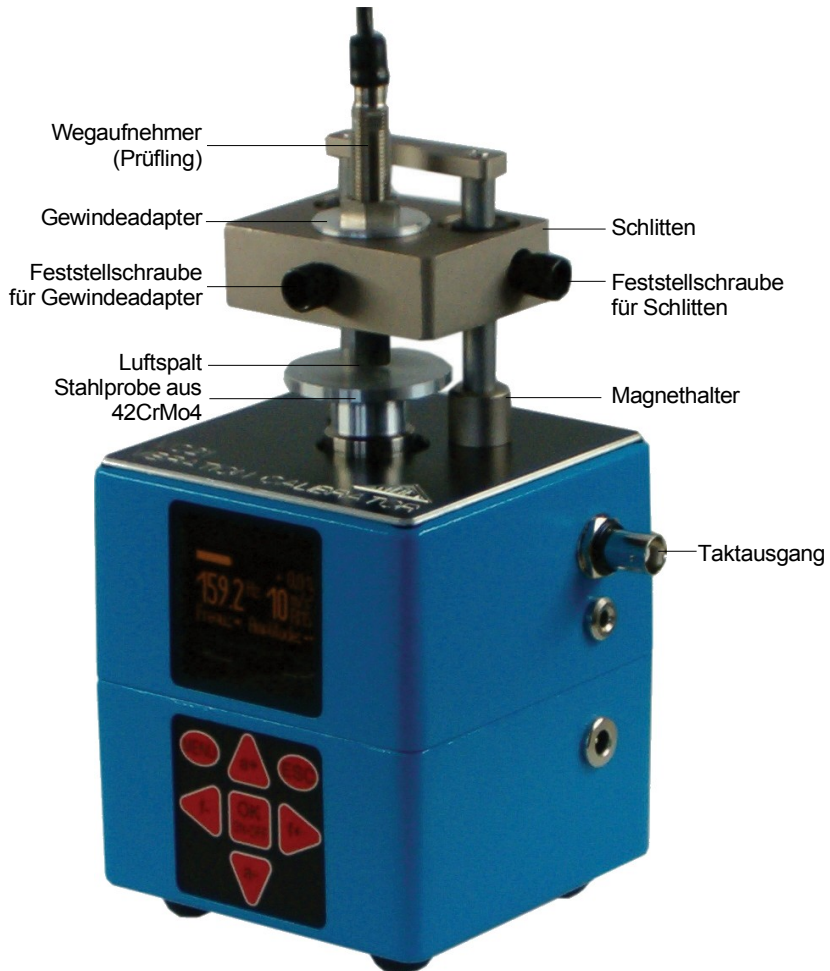
Bild 2: VC21D mit Adapter für Wegaufnehmer und Taktausgang
