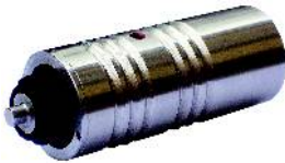
Bild 19: Beschleunigungsaufnehmer mit beweglicher Tastspitze KST94
